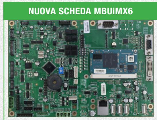
Oltre alla sostituzione dei componenti obsoleti la nuova scheda MBUIX6 è stata progettata per utilizzare un nuovo modulo grafico **più performante**, una memoria **RAM integrata**, un secondo canale di acquisizione dei segnali dei pick-up ed un **buzzer di intensità sonora modulabile**.
